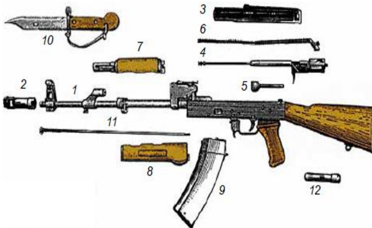
Рисунок 19 – Основні частини та механізми автомата АК-74
