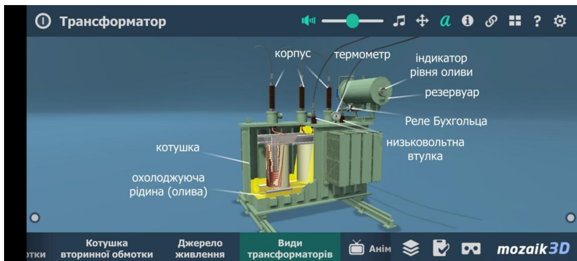
Рис. 7. Будова силового триобмоткового трансформатора
